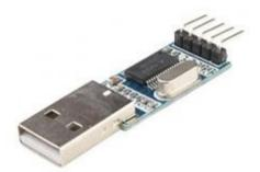
Figure 4 – USB-TTL Converter PL2303HX USB-UART
